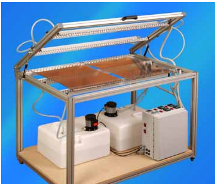
Bei dünneren Zuschnitten wird nur die Unterheizung aktiviert
