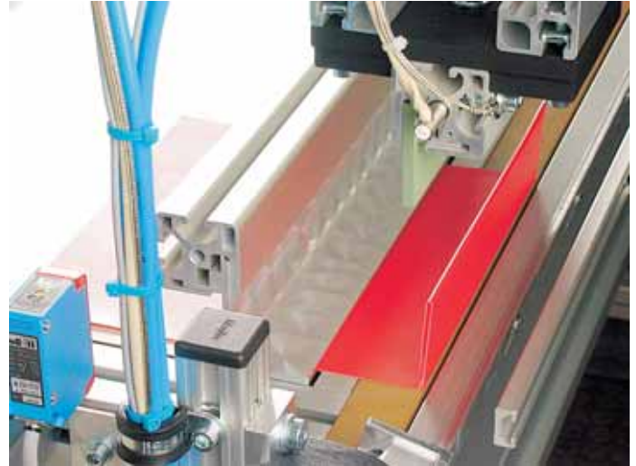
MultiClap erwärmt die Folie linear mit einem Heihschwert von oben und klappt sodann mit der Wange den Schenkel um
