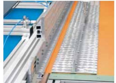
Nach dem Erwärmvorgang kantet die Wange den gewünschten Winkel, hier 90° (max. 190°) bei einer Schenkelbreite von 7 mm auf 3 m. Die Komponenten fahren zurück, das Teil wird entnommen.
