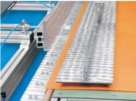
Nach dem Einlegen und Anschlagen der Platte fährt der Niederhalter herab,
