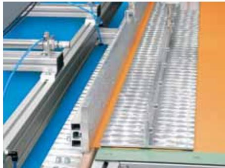
wird das - mit einer PTFE-Folie abgedeckte - Heizband aktiviert, wobei ein zweiter Niederhalter als Erwärm-Konterstück ein Verwellen des thermoplastischen Materials verhindert.
